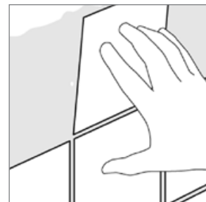
6. Påfør dækklag herefter forsynes fladen på korrekt vis med en dekorativ belægning. Ved fliseopsætning anbefales det med at bruge klæbe- og fugemørtel ekstra tætnende virkning.
