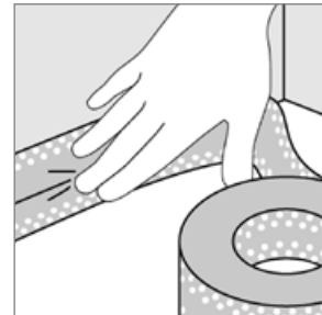
3. Indlægning af tætningsbånd i hjørnerne og fugerne
