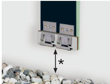
\*Die Holzunterkonstruktion muss mindestens 300 mm über der wasserführenden Ebene liegen (bei Kiesschüttung). Bei glatten Böden und starker Bewitterung erhöht sich der Spritzwasserbereich auf bis zu 500 mm Höhe.
