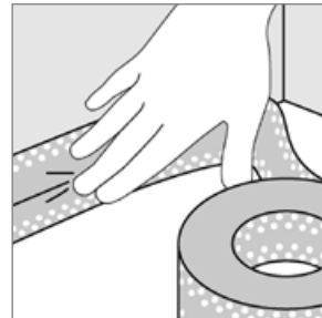
3. Indlægning af tætningsbånd i hjørnerne og fugerne
