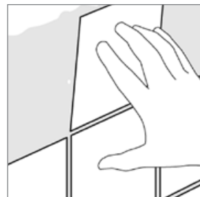
6. Påfør dæklag herefter forsynes fladen på korrekt vis med en dekorativ belægning. Ved fliseopsætning anbefales det med at bruge klæbe- og fugemørtel ekstra tætnende virkning.
